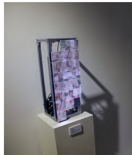
圖 16 作者，〈靜態像素介面系列作品〉，RGB LED 陣列光板、Arduino 晶片、鋁架、電源供應器，53×20×25cm，2020，作者提供。
